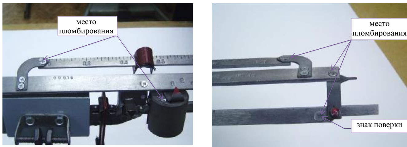
Рисунок 2 – Схема пломбировки от несанкционированного доступа и обозначение места нанесения знака поверки
